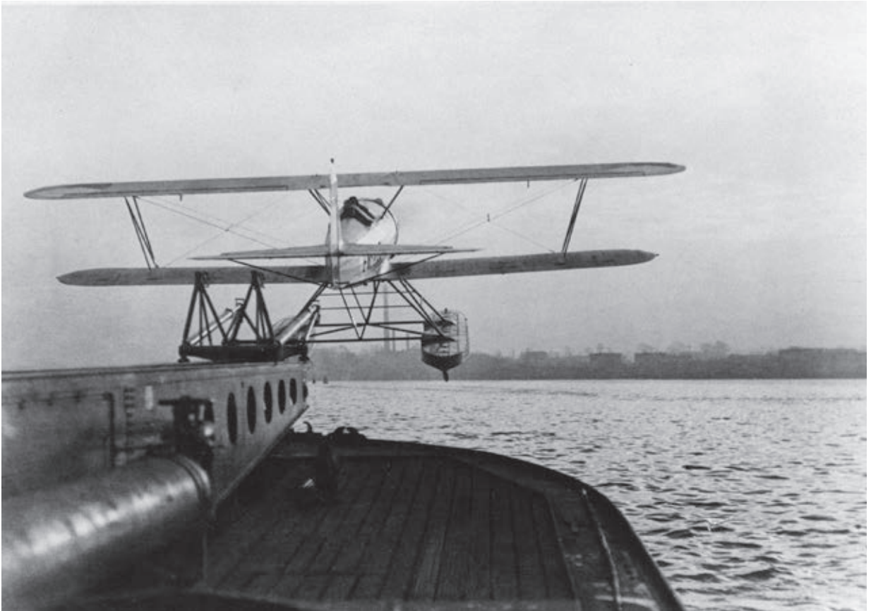
Een Fokker C.XI W in gebruik als kruiservliegtuig met MLD registratie wordt gelanceerd vanaf de katapult. Foto: NIMH.
